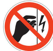
Р 09 Запрещается прикасаться. Корпус под напряжением
