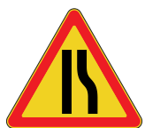
1.20.2 Сужение дороги справа
