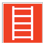
F 03 Пожарная лестница
