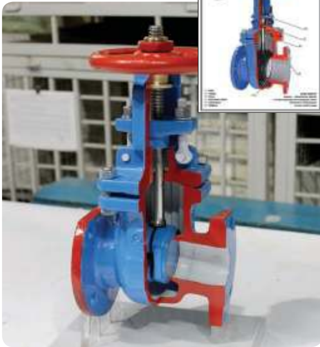
Обучающий макет «Задвижка Ду-50 в разрезе»
