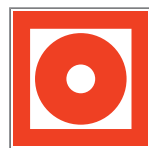
F 10 Кнопка включения установок (систем) пожарной автоматики
