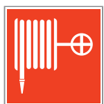
F 02 Пожарный кран
